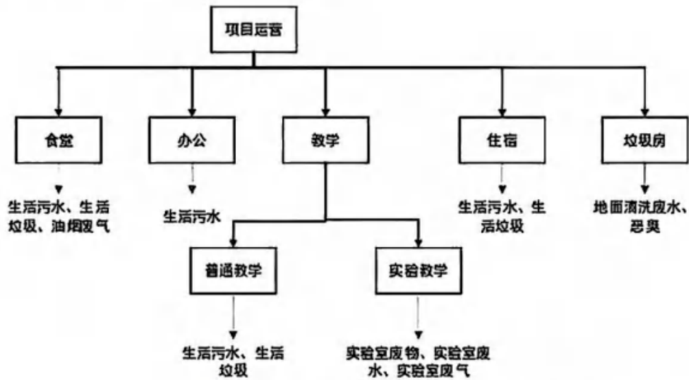
图 2-2 试运营期工艺流程及产污环节图
